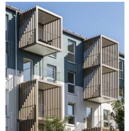
Dämmung und einer Putzfassade. Ergänzt werden die Gebäude durch ein vorgesetztes Balkonsystem mit Alu-Hohlprofil-Lamellen. Durch die vorgesetzte Balkonzone bekommt die Fassade eine klare Strukturierung. Im Zusammenspiel mit der Verwendung verschiedener Putzarten entsteht ein harmonisches Fassadenbild. So wurde das Obergeschoss mit einem Besenstrichputz in gedeckten Blautönen abgesetzt, wohingegen für die unteren Geschosse ein neutraler Feinputz gewählt wurde.
