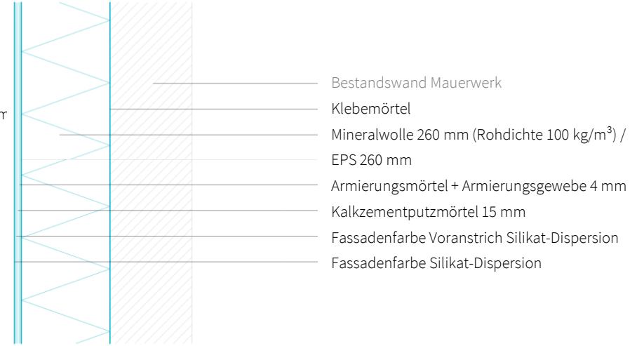
Fassade WDVS Mineralwolle / WDVS EPS
