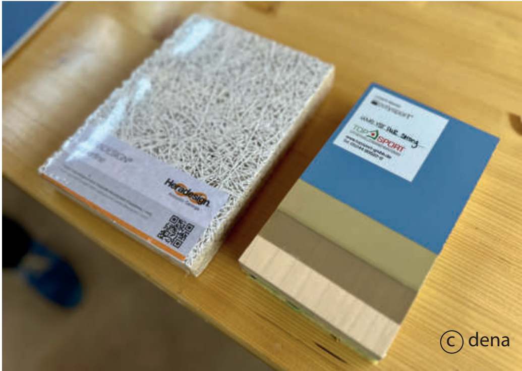
Abgehängte DEcken in Halle und Umkleiden aus Herkli Schwingboden in der Halle
