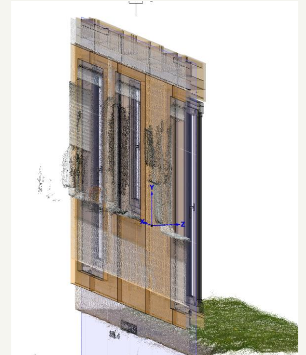
Punktwolke + überlagertes Holzrahmen-Element · Abbund Dietrich · Projektaufnahmen Holzbau Dawen
