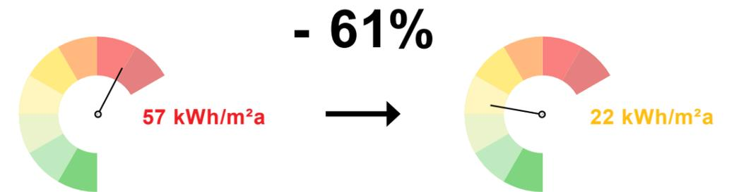
Verbesserung des Energieverbrauchs um **61%** durch **Lüftungsgeräte mit WRG**
