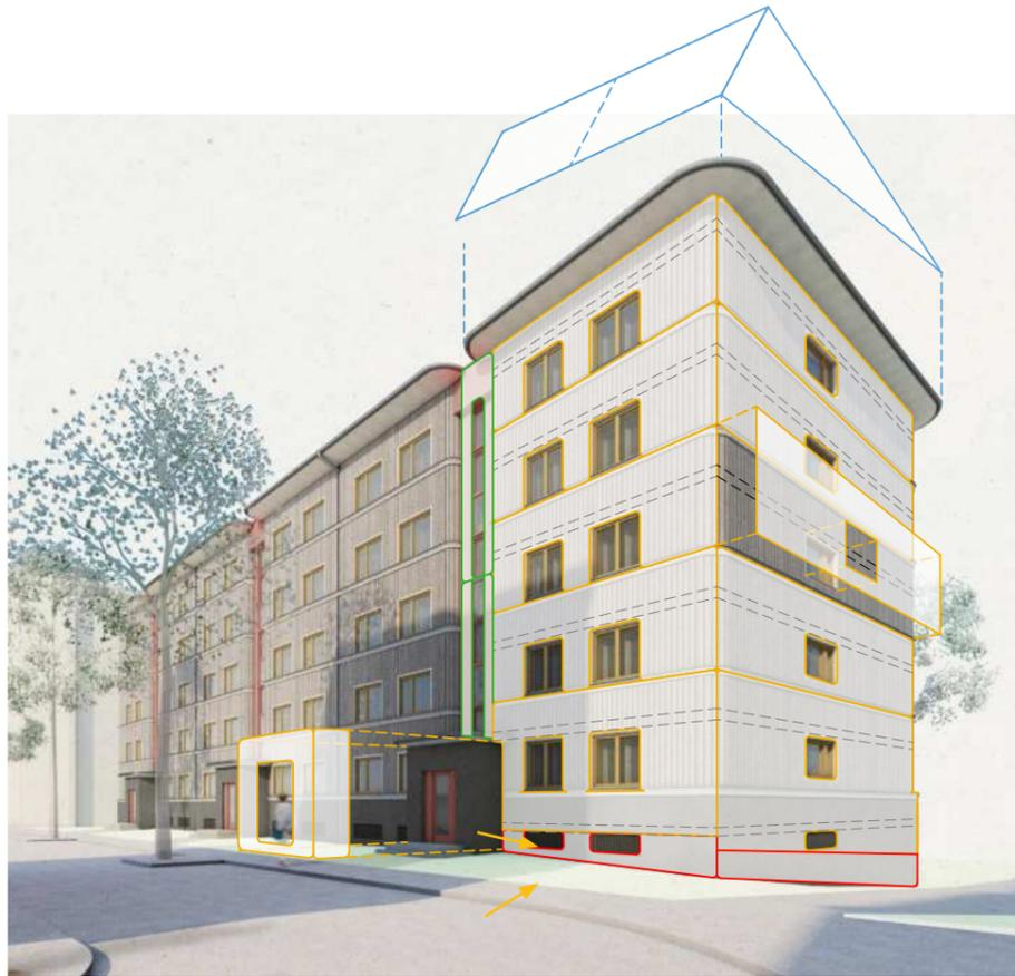
schematische Darstellung der Modulaufteilung für die serielle Sanierung
