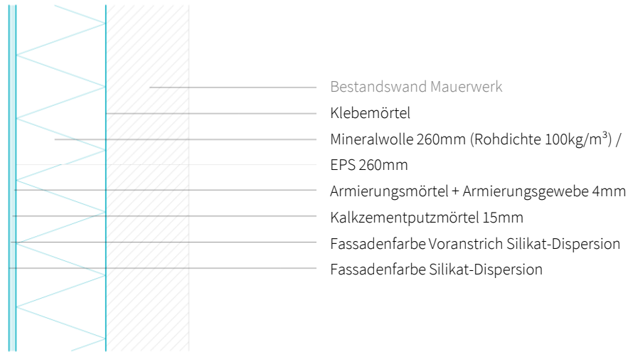
Fassade WDVS Mineralwolle / WDVS EPS
