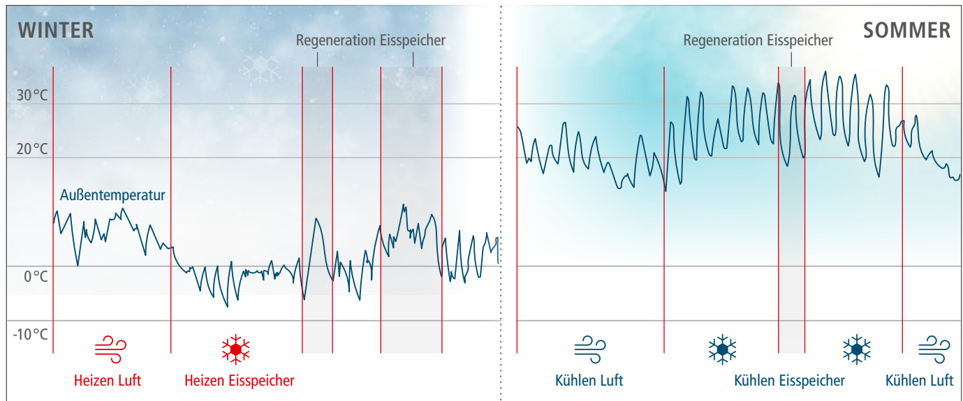
Funktionsprinzip des Luft-Eisspeichers im jeweiligen Betriebsmodus – exemplarisch ein Monat im Winter- bzw. Sommerbetrieb
